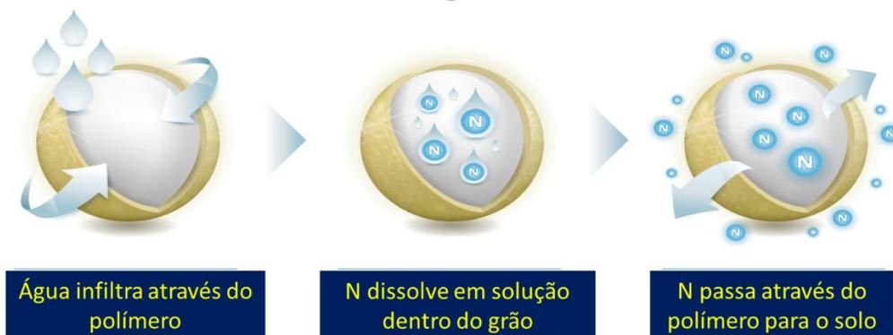
A água não infiltra através do polímero que é impermeável, mas o vapor de água entra bem facilmente atravessando a camada de polímero chegando dentro do grão, e após condensar internamente dentro do grão dissolverá o nutriente internamente formando uma solução que tende a escapar por difusão de modo gradual e constante ao longo do tempo programado.
